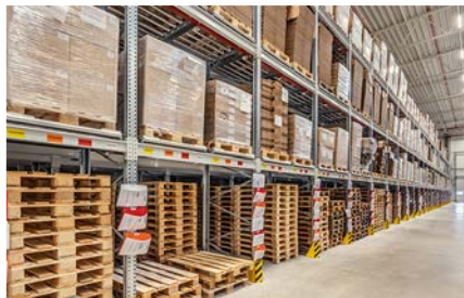
Ein rund 54 Meter breites Einschubregal ermöglicht die hochkompakte Lagerung von Verpackungen und Paletten.
